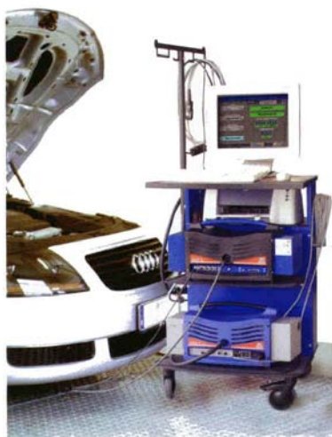
Analizador combinado de MGT 5 con MDO 2 LON en un carrito. En una sola estación se realizan los análisis de los gases de motores Otto o Diesel. Es posible el uso individual y móvil de cada uno de los aparatos.
