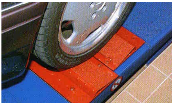
Fig. 2.24 Placas de prueba
